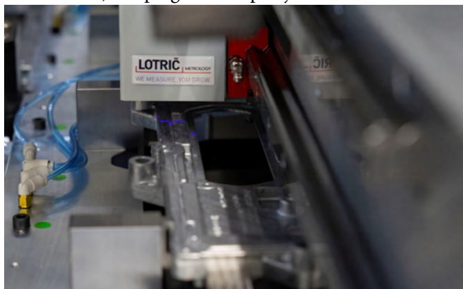
Slika 2: Merilni sistem TRAMES za kontrolo toplotnih razpok. Viden je del merilne glave, ki nad ulitkom izvaja brezkontaktno lasersko skeniranje. Ulitek je med merjenjem z laserskim senzorjem fiksiran na namenski pripravi.
