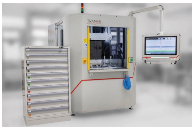
Slika 3: TRAMES sistem za avtomatsko kontrolo toplotnih razpok na ulitkih je integriran na obstoječi proizvodni liniji kot samostojna merilna celica v industrijskem okolju. Ohišje merilnega stroja vsebuje vso potrebno mehanizacijo in senzoriko; na desni strani je viden krmilno-analizni vmesnik (ekran na katerem se prikazujejo rezultati vsakega pregleda). Sistem ne vpliva na hitrost proizvodnje.
